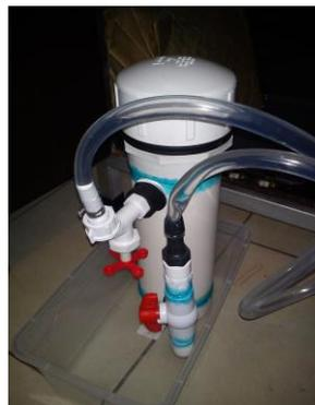
5. Encender y probar que circule el agua y no existan fugas.
